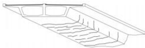
[그림 1.9] PSC 박스거더의 균열
